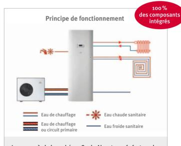
La pompe à chaleur air/eau Genia Air est un générateur de chauffage et d'ECS écologique qui combine l'énergie puisée dans l'air (70 %) et l'énergie électrique (30 %). Pour maximiser les performances, le confort et l'intégration, Genia Air est associé à GeniaSet, une colonne hydraulique double service, intégrant régulateur du générateur, appoint électrique et préparateur ECS.
